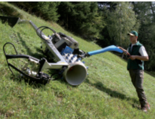
Der Mäher mit der größten Arbeitsbreite ist im Steilhang am sichersten zu manövrieren, verursacht die wenigsten Narbenschäden und Futtermittelschmutzungen.
