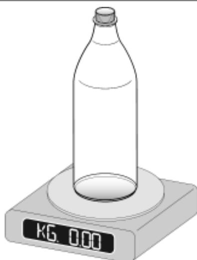
Mettre la bouteille en plastique vide sur la balance. Mettre à zéro la balance à la valeur " kg = 0.00 ".
