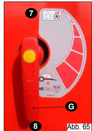
**Anmerkung:** Alle Zwischenpositionen sind möglich, damit die Stärke des Mischvorgangs auf Grund der Menge und der Art des verwendeten Produkts eingestellt werden kann.
