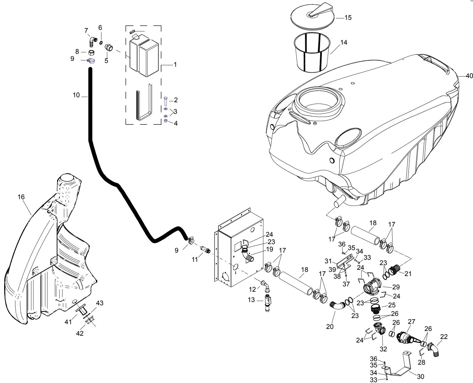
**Cisterna e valvola di scarico / Tank and drain valve**
