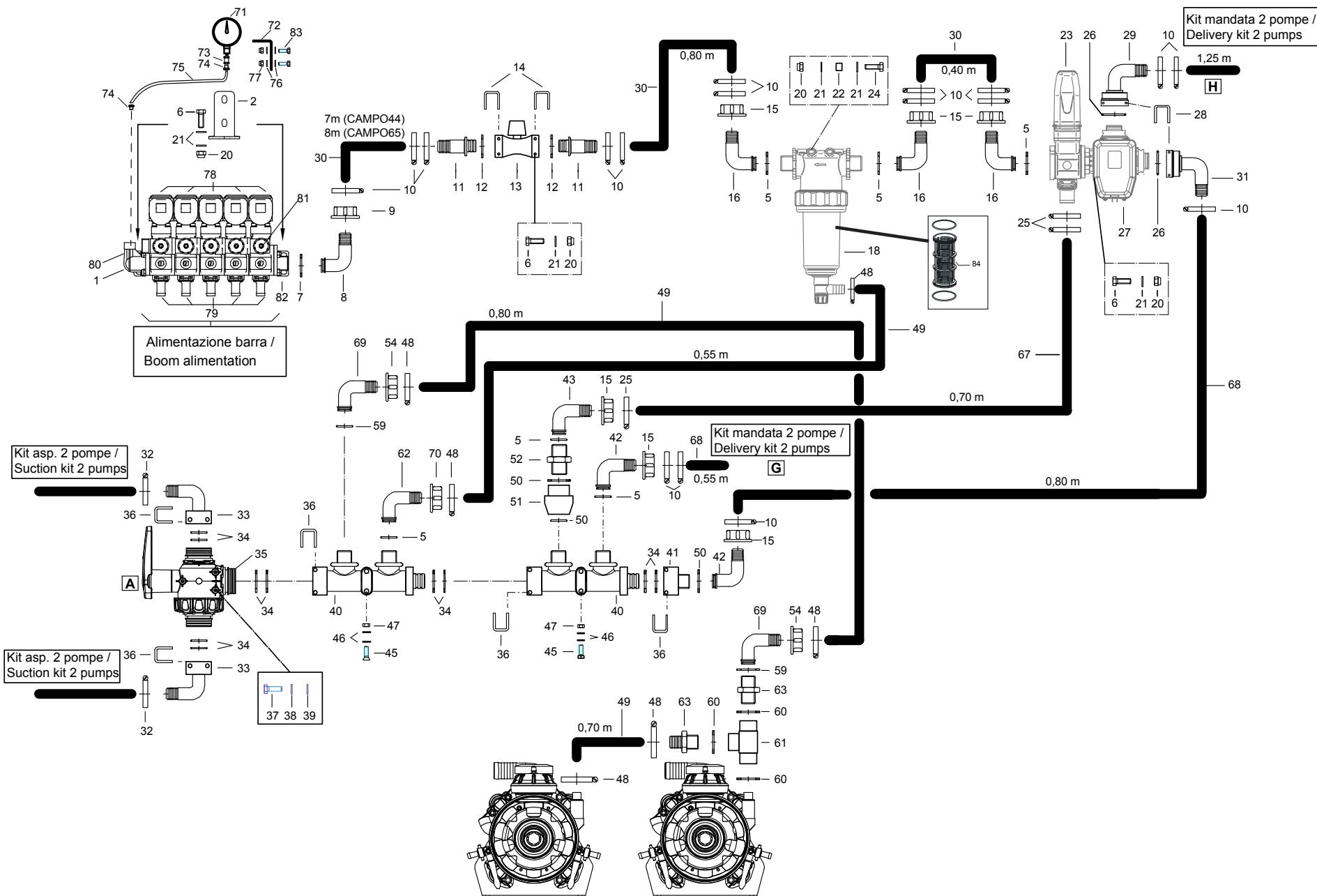
**Collettore scarichi + gruppo di comando con due pompe / Collector drain + control device with 2 pumps**
