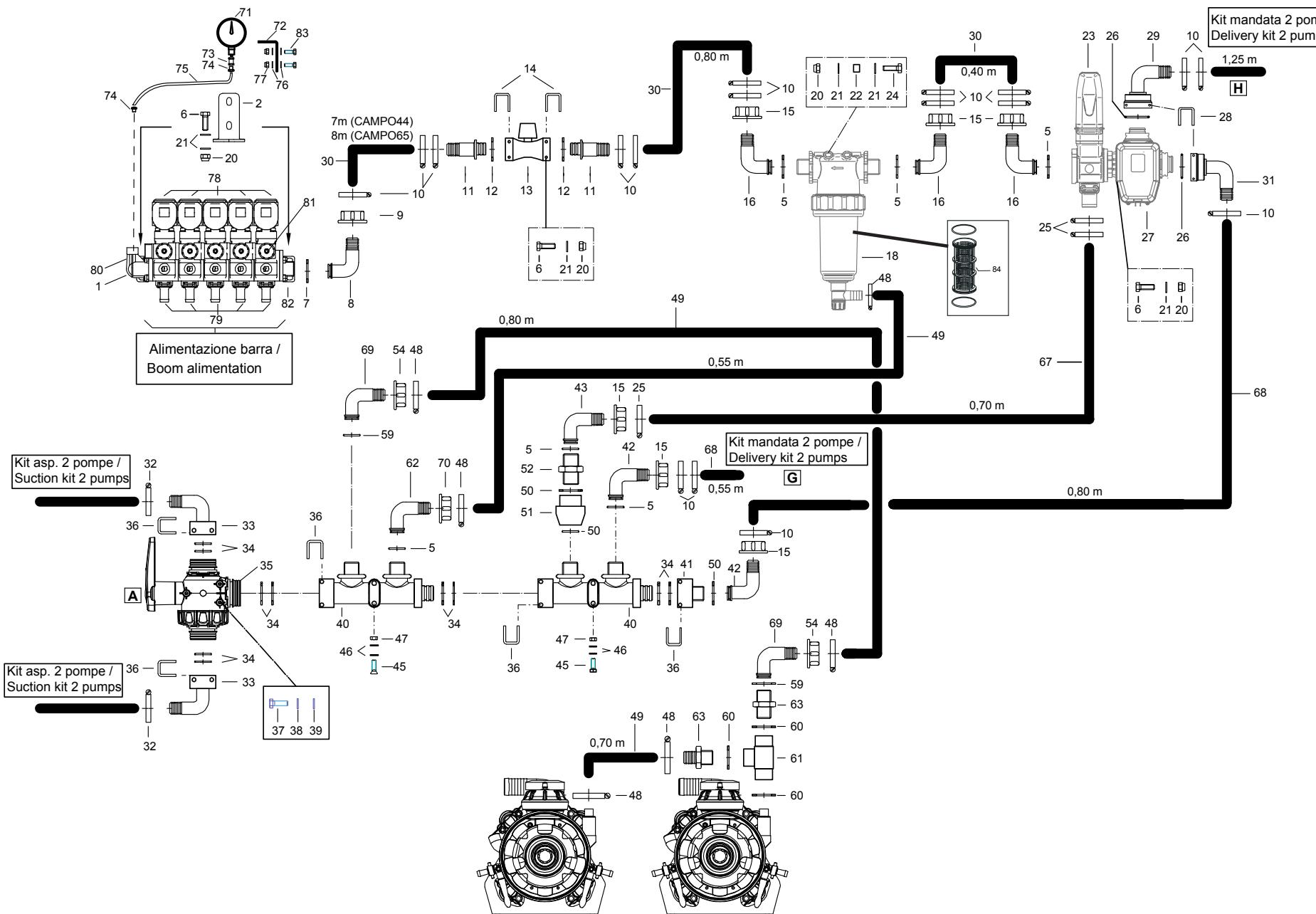
**Collettore scarichi + gruppo di comando con due pompe / Collector drain + control device with 2 pumps**
