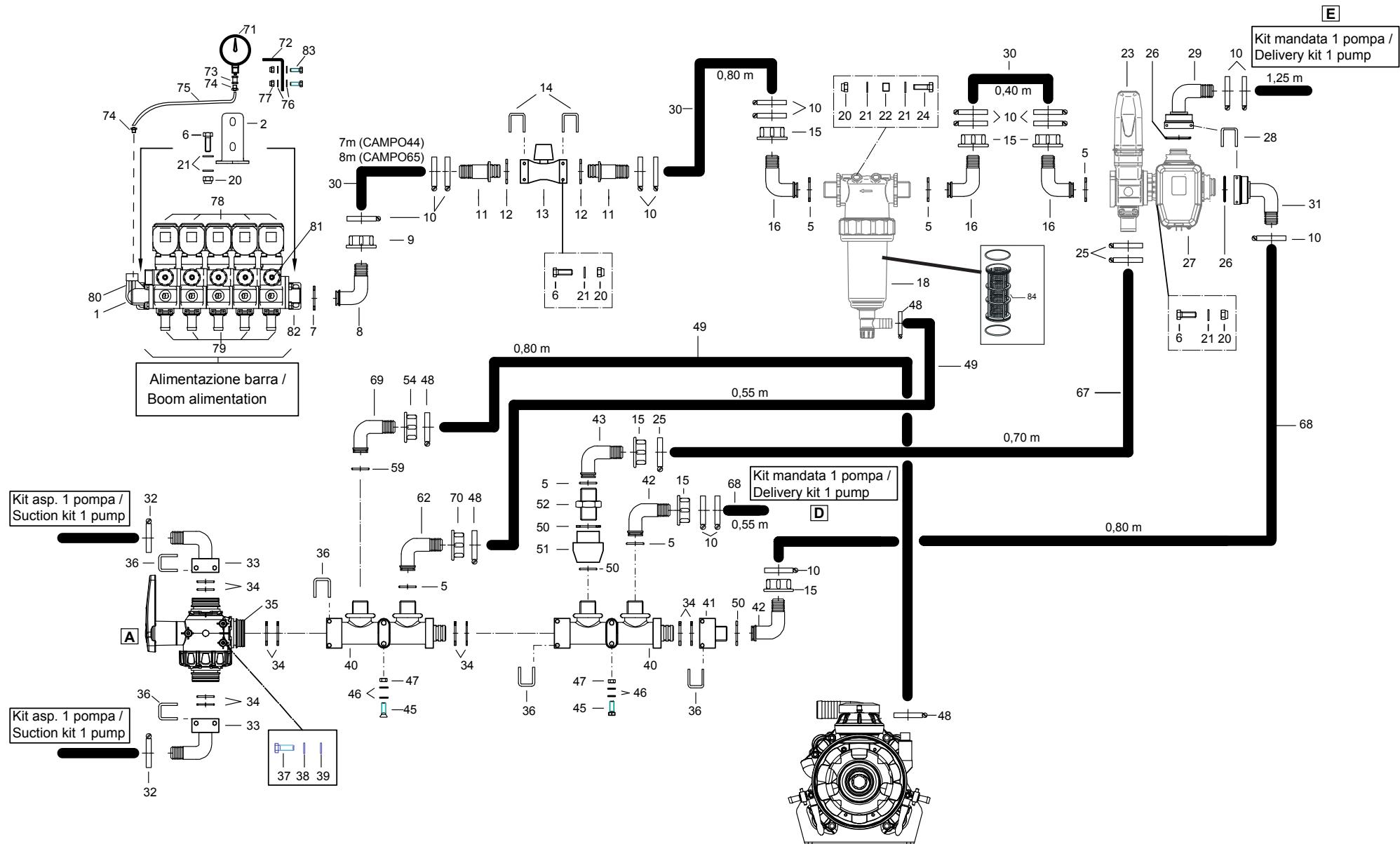
**Collettore scarichi + gruppo di comando con una pompa / Collector drain + control device with 1 pump**
