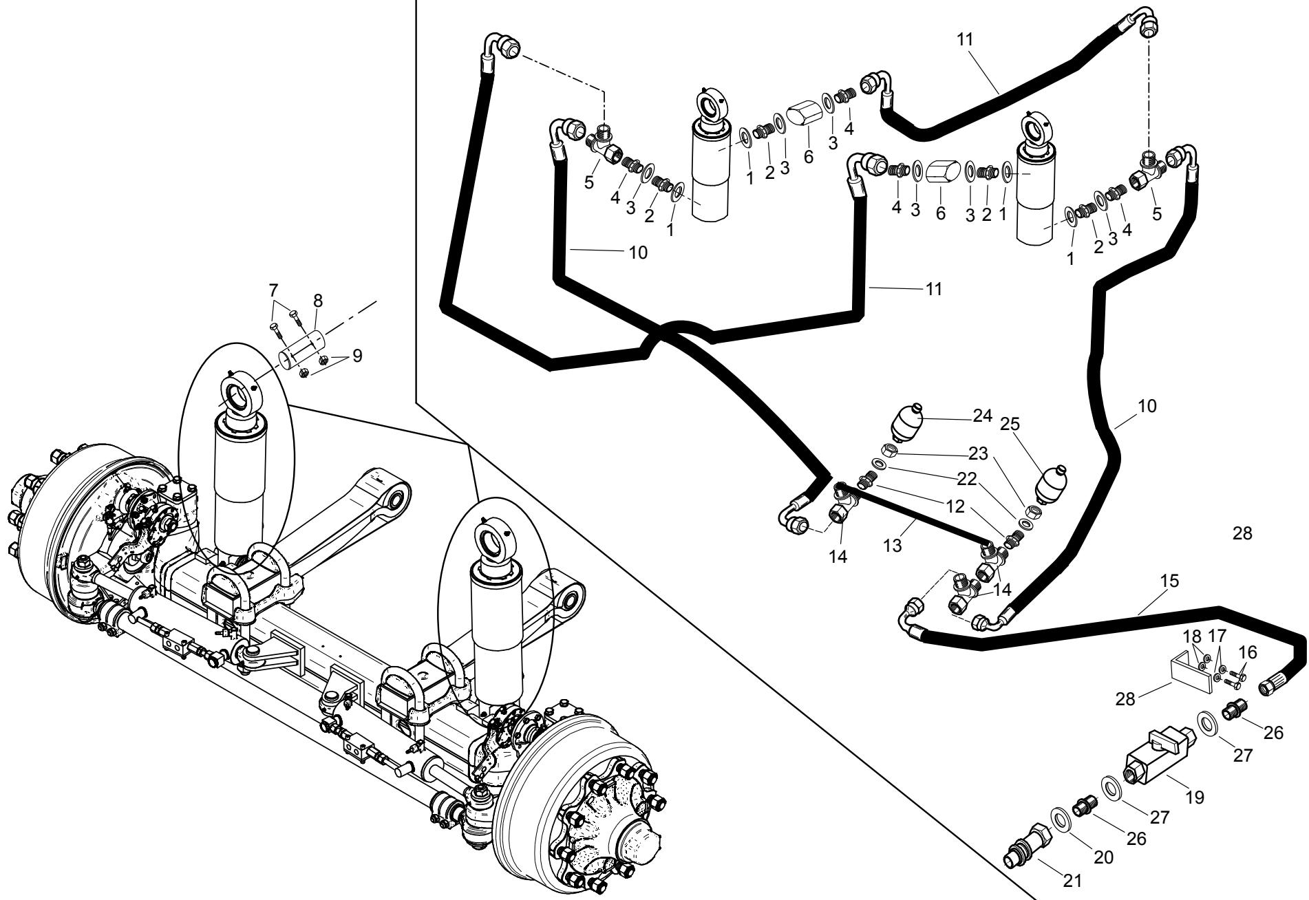
**Collegamenti sospensioni con assale sterzante / Steer axle connections suspension**
