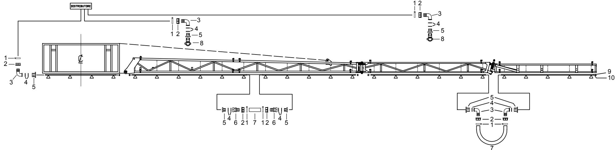
SCHEMA ALIMENTAZIONE TUBI SPRAYERS CON ADATTATORI OTTONE D13
