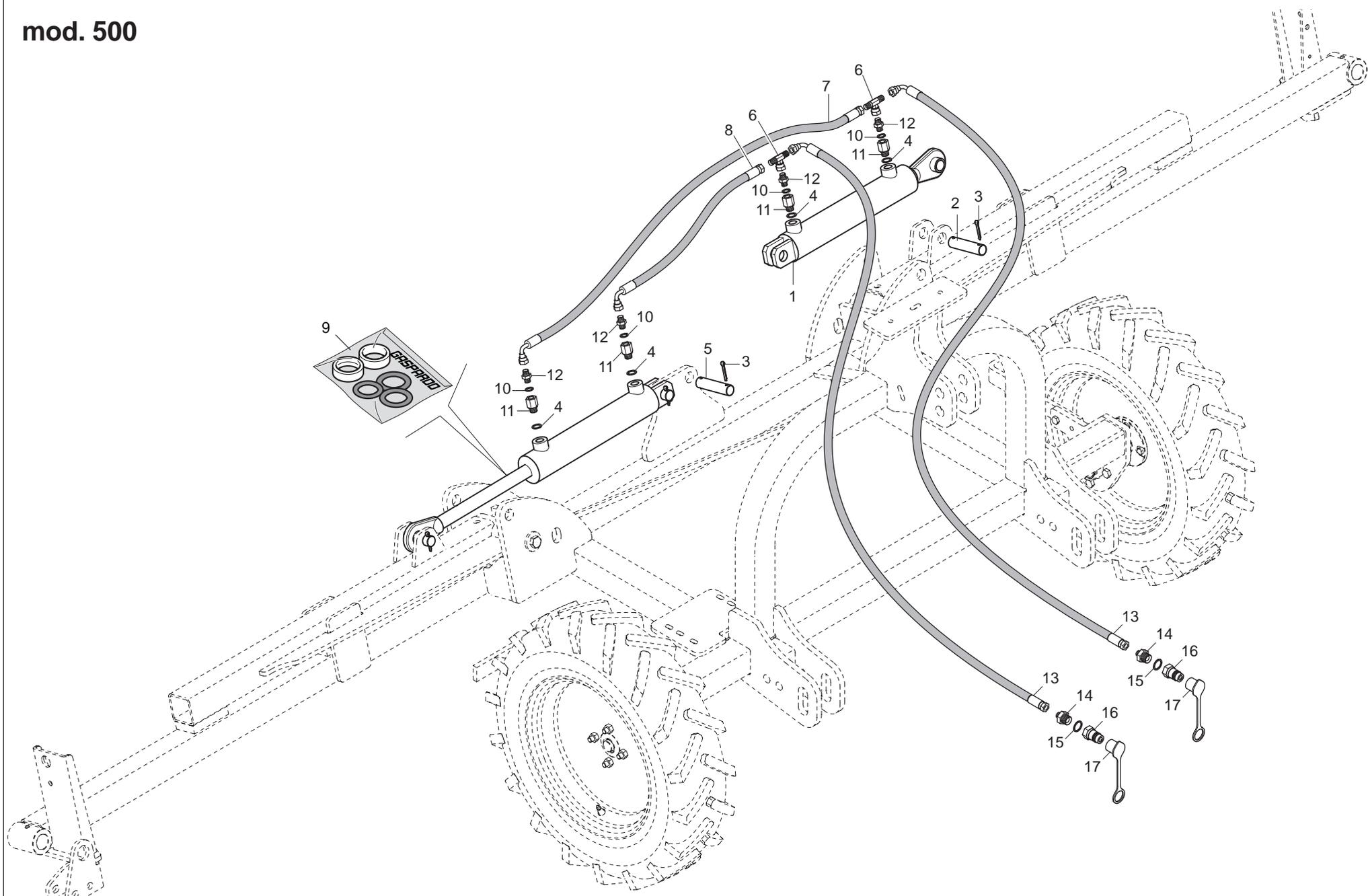
**IMPIANTO OLEODINAMICO TELAIO «mod. 500»**
