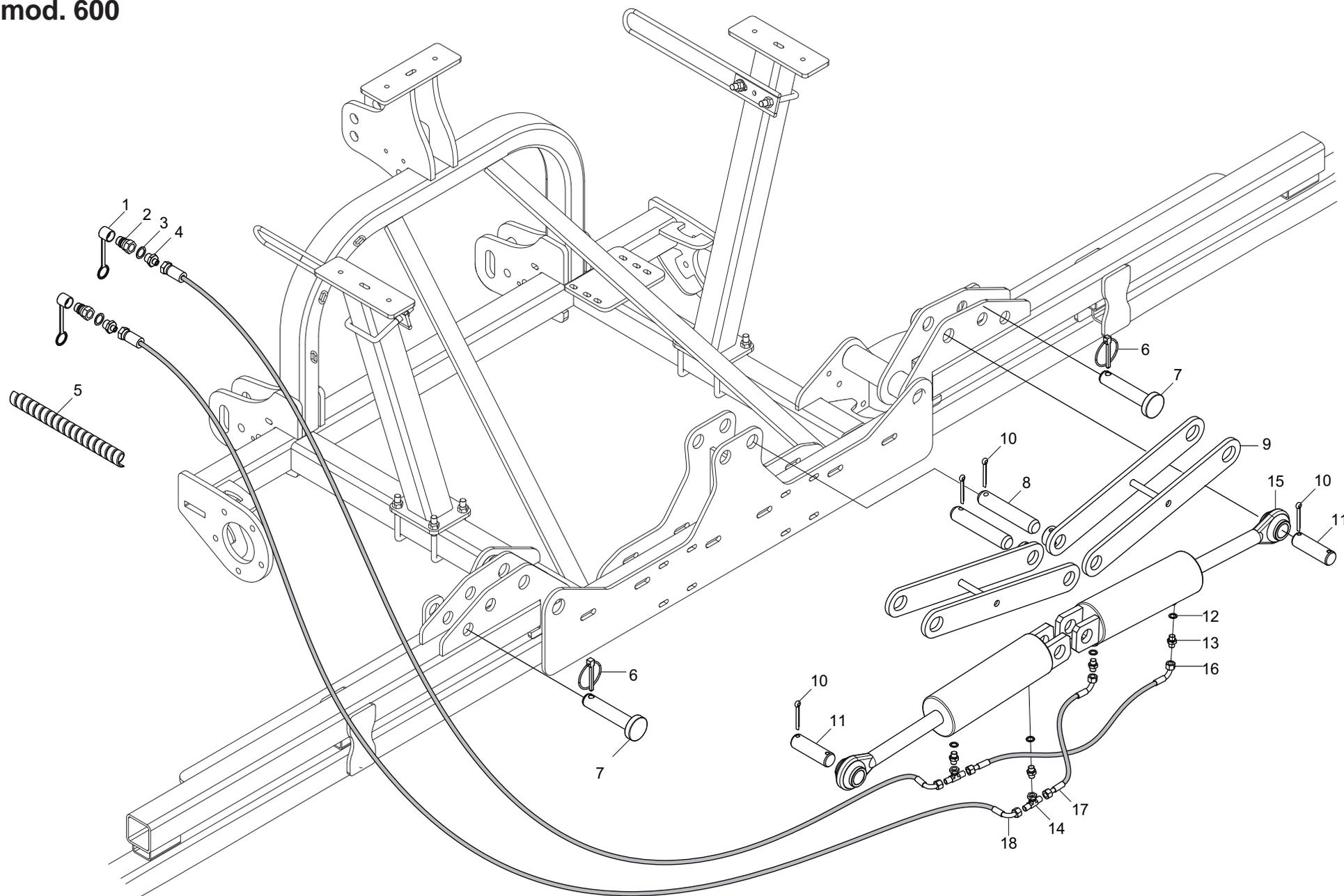
**IMPIANTO OLEODINAMICO TELAIO «mod. 600»**
