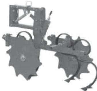
Hackaggregat mit 3 Federzinken - 2 gezackte Schutzscheiben
